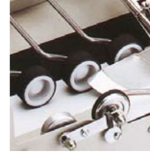
De automatische dikte instelling is zeer praktisch. Dikke en dunne enveloppen worden allemaal even goed gesloten!
